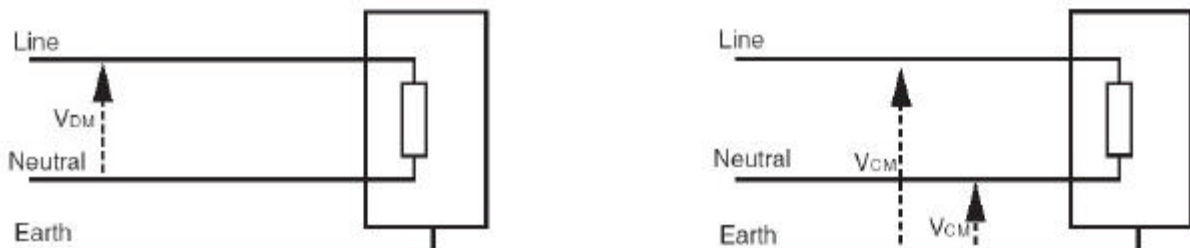
Bild 1: Auftreten symmetrischer (links) und asymmetrischer (rechts) Störgrössen
